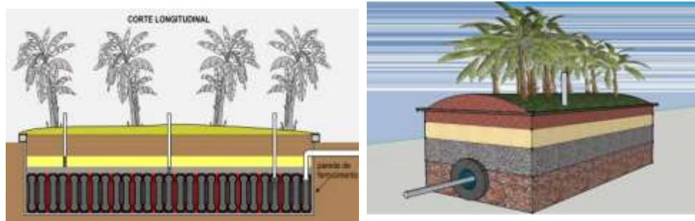
Figura – 6: ilustração do perfil transversal da fossa ecológica
