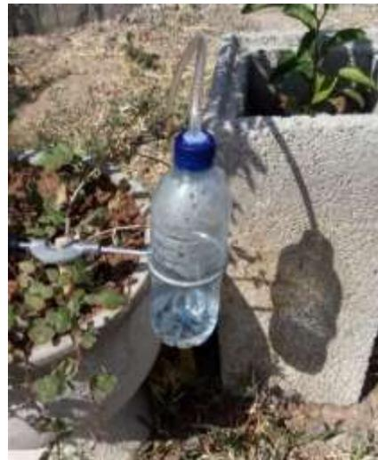
Desconsiderando algumas gotículas que foram perdidas através da mangueira, podemos considerar a seguinte hipótese: se fossem utilizadas 1000 garrafas semelhantes a esta, nessas mesmas condições, a quantidade de água que seria obtida ao final de 30 dias, seria equivalente a 120 litros. Levando em consideração, que em média uma pessoa de 80kg deve consumir 2,8 litros de água por dia, essas mil garrafinhas teriam a condição de abastecer o consumo desta pessoa por cerca de 42 dias.
