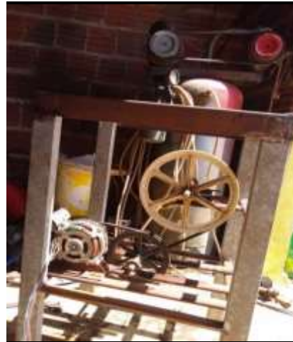
ADAPTAÇÃO FEITA NO MOTOR, PARA REDUZIR A VELOCIDADE E AUMENTAR A FORÇA DA LAMINA DE CORTE
