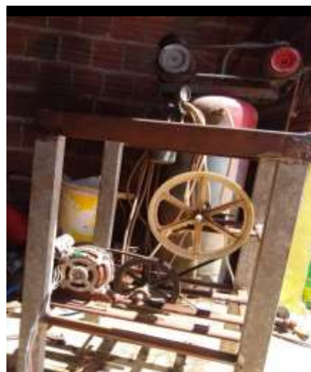
ADAPTAÇÃO FEITA NO MOTOR, PARA REDUZIR A VELOCIDADE E AUMENTAR A FORÇA DA LAMINA DE CORTE
